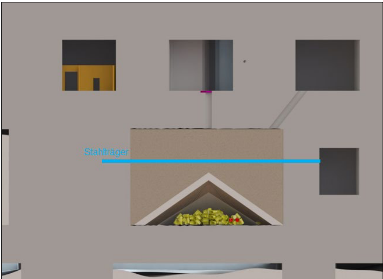
Abbildung 50: Mit Stahlträgern oder Seilankern gesicherter Versatzkörper.
