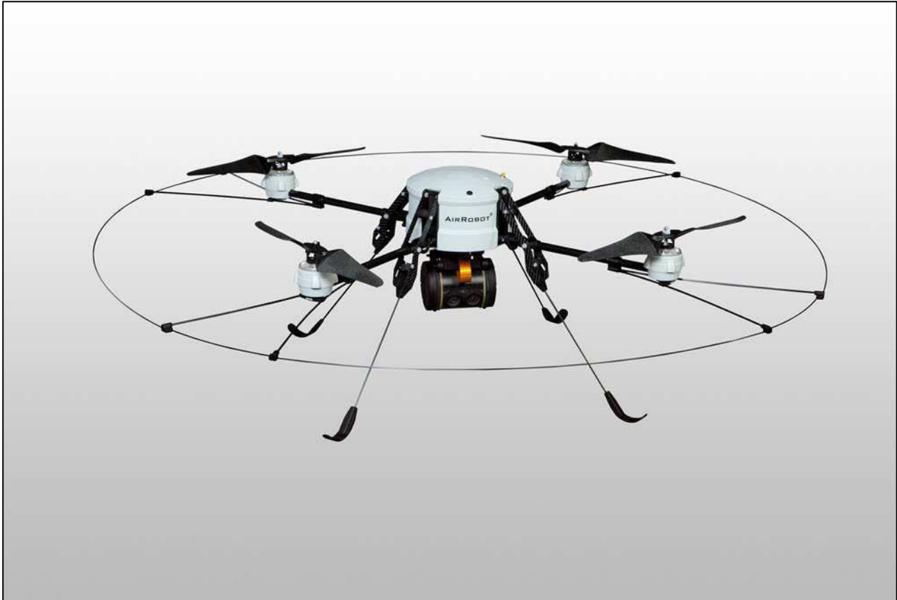
Abbildung 31: Drohne für Arbeiten in der ELK 8a/511
