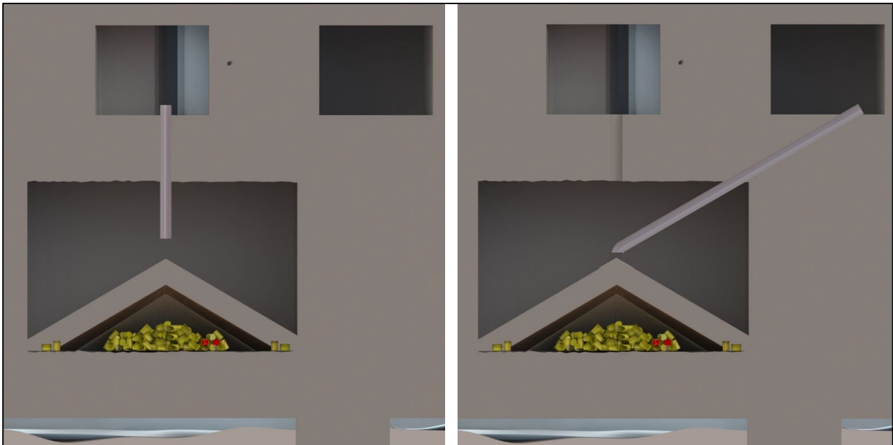
Abbildung 19: Einbringen einer Haufwerkschüttung
