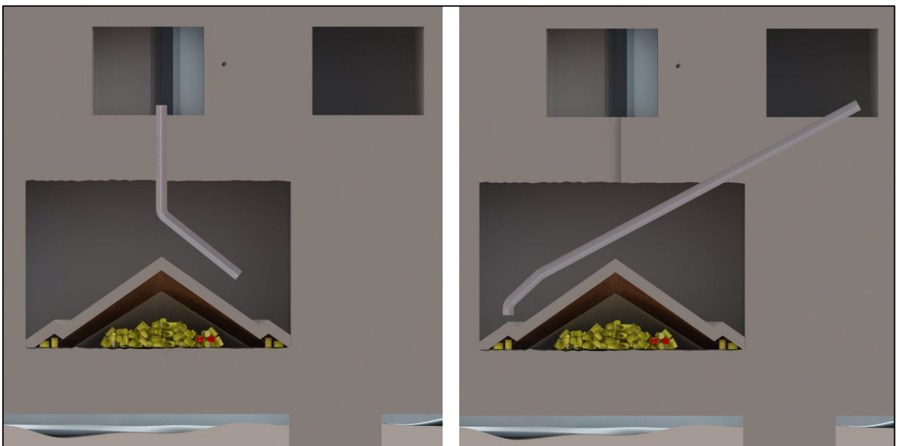
Abbildung 20: Profilgenaue Haufwerkschüttung mit verstellbarem Austrag
