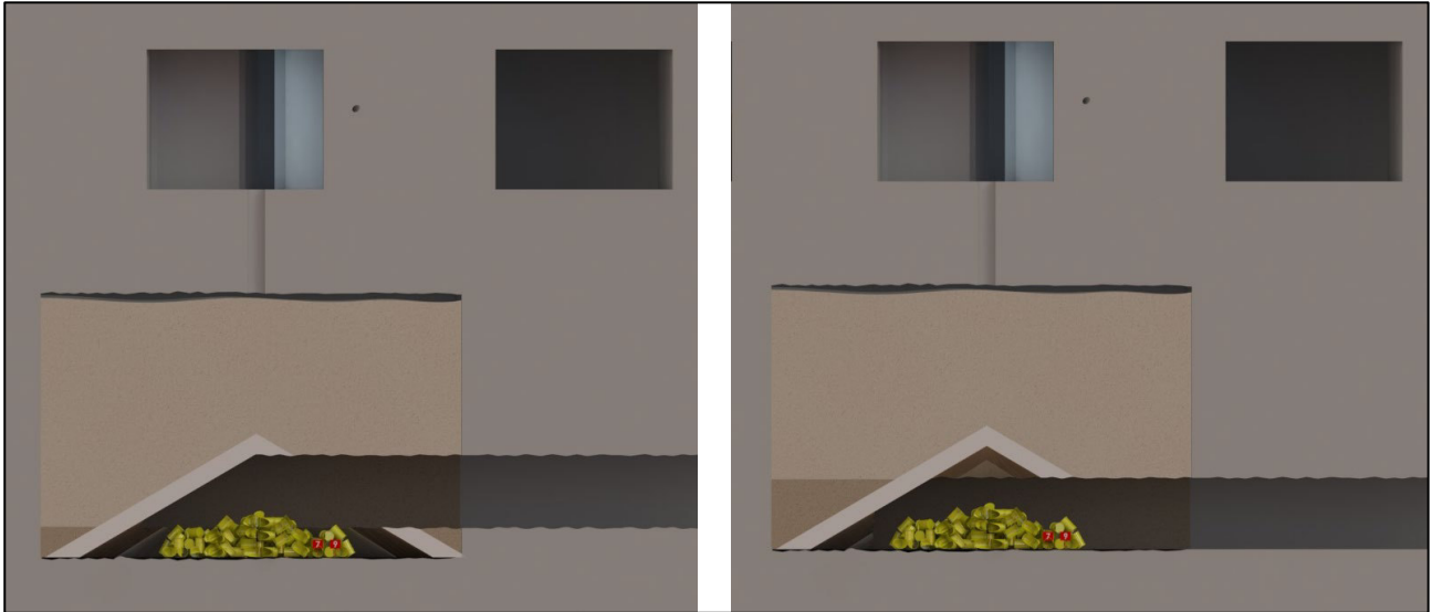
Abbildung 46: Zugang auf halber Höhe des Gebindekegels (links) und im Niveau der ELK-Sohle (rechts)
